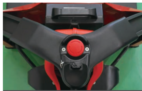
非常停止ボタン
